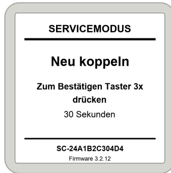
Bestätigung am Cube 3-mal drücken innerhalb von 30 Sekunden.
